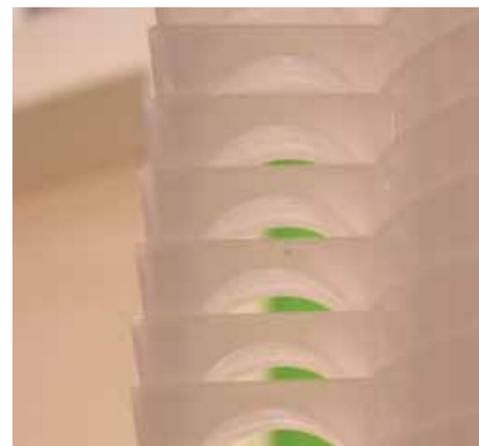
Por ser de polipropileno, material similar al polietileno, las piezas pueden ser lavadas en lavatrastes automáticas, ya que es un material que no funde por debajo de 160°C. Esto es, El polietileno, un plástico más común, se recalienta a aproximadamente 100°C, lo que significa que los platos de polietileno se deformarían en el lavaplatos.
