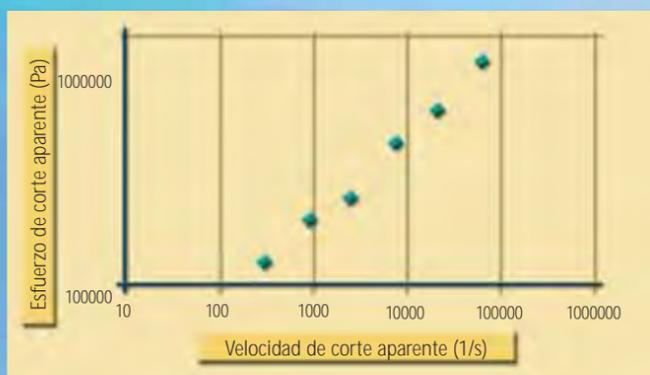
FIGURA 6. ESFUERZO DE CORTE, OBTENIDO POR REOMETRÍA CAPILAR, PARA EL POLIETILENO (PE) DE ALTA DENSIDAD.
