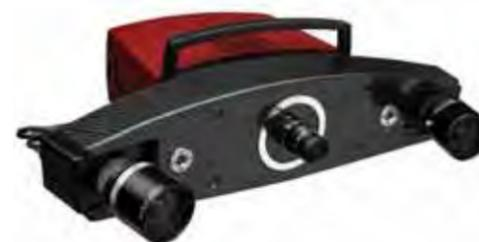
CON BASE EN UN PRINCIPIO DE TRIANGULACIÓN, EL DIGITALIZADOR USA UN ARREGLO REDUNDANTE DE INFORMACIÓN A PARTIR DE DOS CÁMARAS DE VIDEO; EN ESTE ARREGLO LAS CÁMARAS (A LOS EXTREMOS) Y LA UNIDAD DE PROYECCIÓN (EN LA PARTE CENTRAL) SE INTEGRAN EN EL CABEZAL DEL SENSOR.
