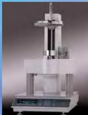
FIGURA 2. MEDIDOR DE ÍNDICE DE FLUIDEZ.
