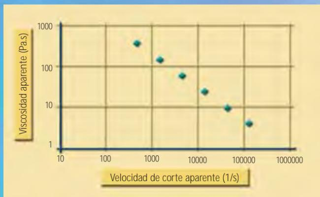
FIGURA 5. VISCOSIDAD EN FUNCIÓN DE LA VELOCIDAD DE CORTE, OBTENIDA POR REOMETRÍA CAPILAR, PARA EL POLIETILENO (PE) DE ALTA DENSIDAD.
